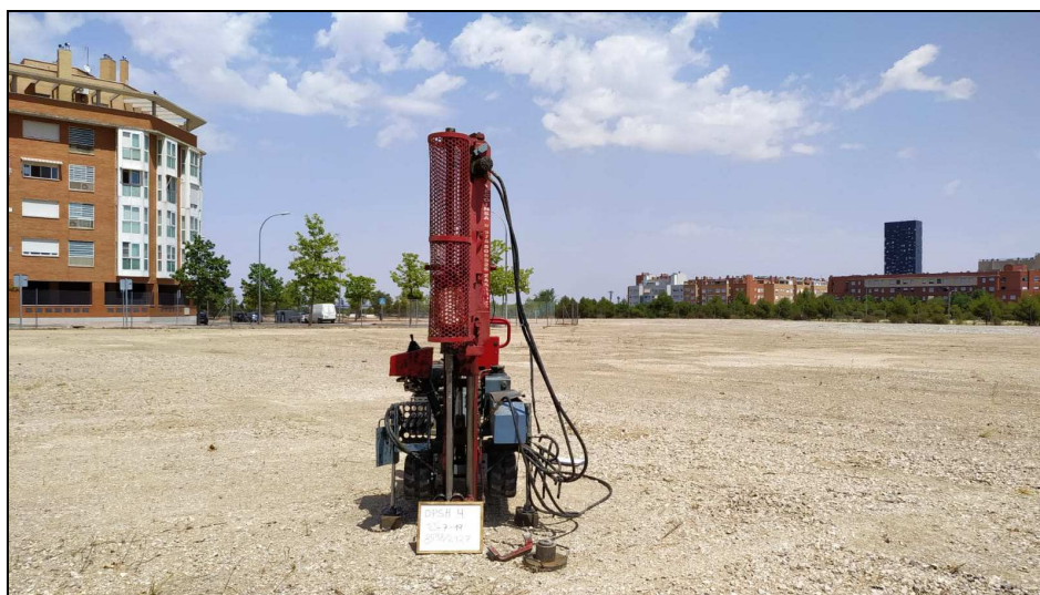
Fotografía 4: Emplazamiento del ensayo de penetración dinámica DPSH nº4 con puntaza perdida
