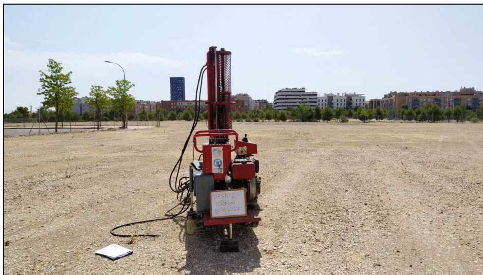
Fotografía 2: Emplazamiento del ensayo de penetración dinámica DPSH nº2 con puntaza perdida
