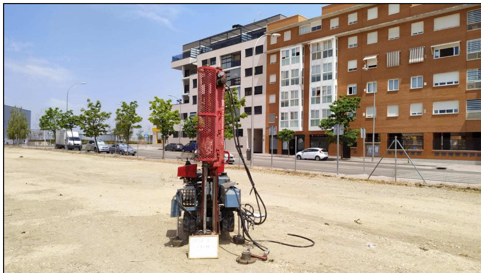
Fotografía 3: Emplazamiento del ensayo de penetración dinámica DPSH nº3 con puntaza perdida
