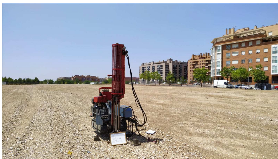
Fotografía 10: Emplazamiento del ensayo de penetración dinámica DPSH nº10 con puntaza perdida
