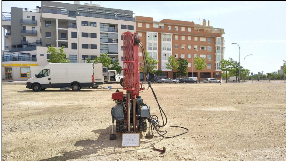
Fotografía 1: Emplazamiento del ensayo de penetración dinámica DPSH nº1 con puntaza perdida
