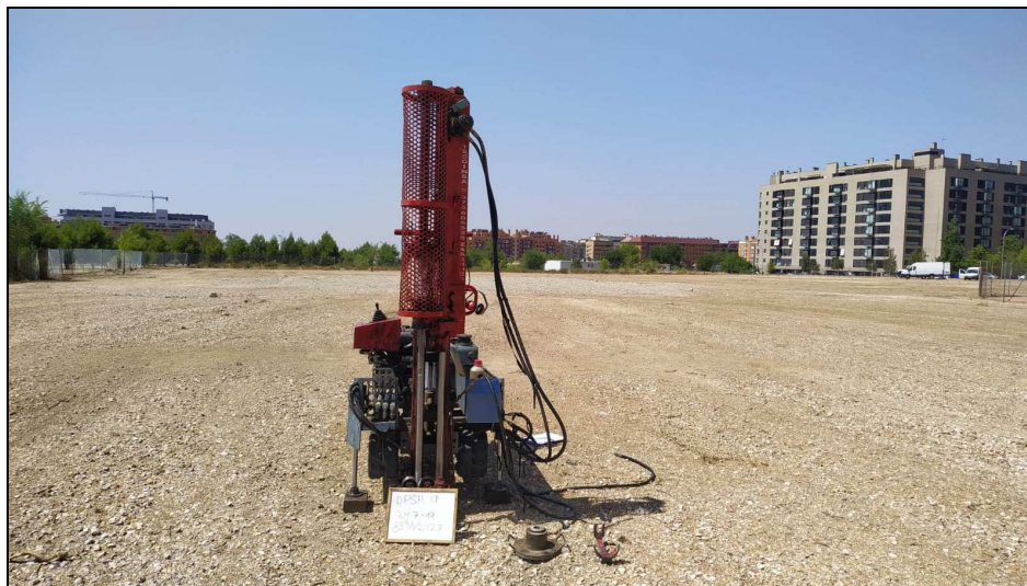
Fotografía 9: Emplazamiento del ensayo de penetración dinámica DPSH nº9 con puntaza perdida
