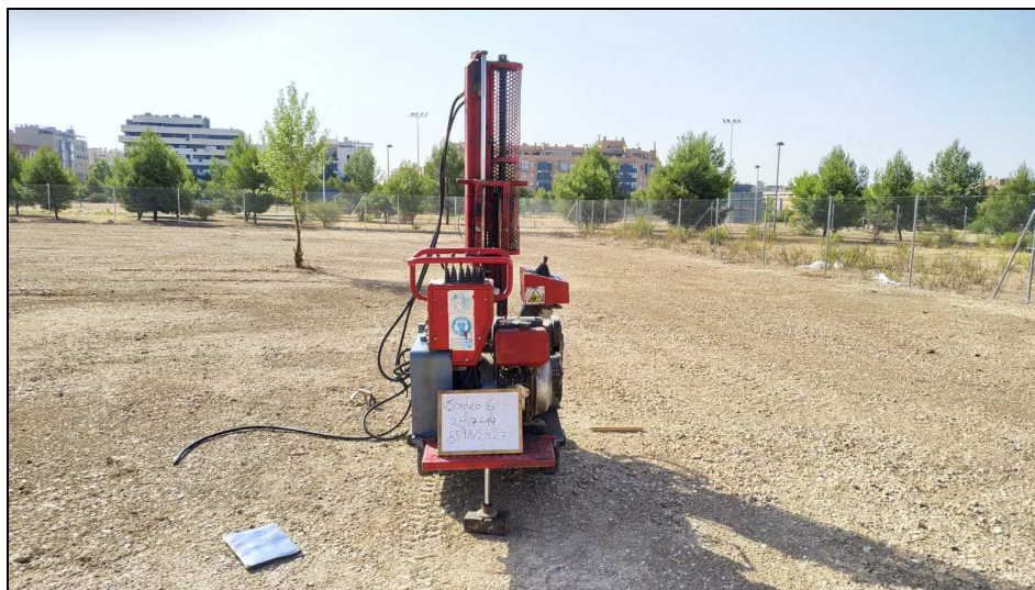
Fotografía 6: Emplazamiento del ensayo de penetración dinámica DPSH nº6 con puntaza perdida
