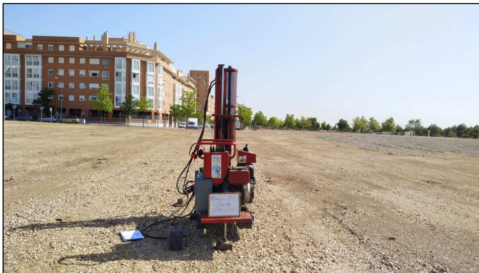
Fotografía 7: Emplazamiento del ensayo de penetración dinámica DPSH nº7 con puntaza perdida
