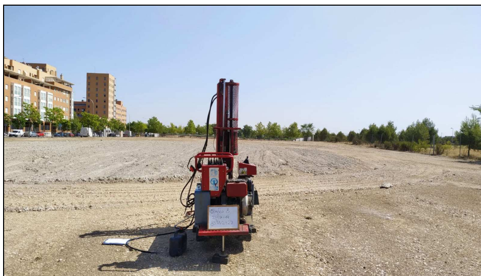
Fotografía 8: Emplazamiento del ensayo de penetración dinámica DPSH nº8 con puntaza perdida
