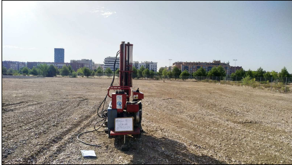
Fotografía 5: Emplazamiento del ensayo de penetración dinámica DPSH nº5 con puntaza perdida
